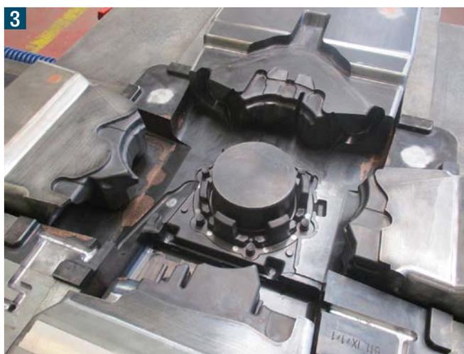
**1. Parte mobile di stampo a una impronta e due carrelli laterali con movimento meccanico tramite colonne inclinate finito e predisposto per il montaggio diretto in pressa completo di**
