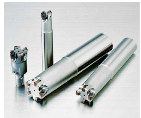
**Utensili a fissaggio meccanico ad alto avanzamento con inserto bilaterale (4 taglienti), le frese Moldino serie TD4N sono indicate per lavorazioni di sgrossatura e semifinitura ad alta efficienza su materiali fino a 55 HRC**
